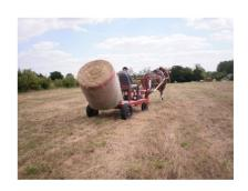
Hipo-Pic-Balle: Outil destiné à la manutention des balles rondes, possibilités de mettre une cuve de 1000 l sur la plate forme - Les Pics peuvent recevoir un caisson genre benne 3 points
