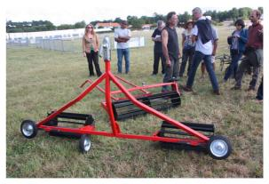
Présenté en position de transport c'est à dire avec le brancard fixe et roulettes sur chacun des rouleaux, le brancard se dégoupille pour le rendre amovible au travail, ce qui est fort utile dans les travaux en pente. Les roues se retirent et se logent dans des fourreaux latéraux avec un dépassement de la bande de roulement, ce qui sert de protection latéral pendant le travail.
