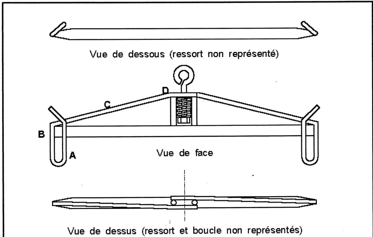
Nota : chaque crochet de trait est réalisé en étiré de 12 d'un seul morceau, boucle prépliée à chaud (A), soudé sur le tube (B) puis plié à chaud en place (C) et soudé (D).
